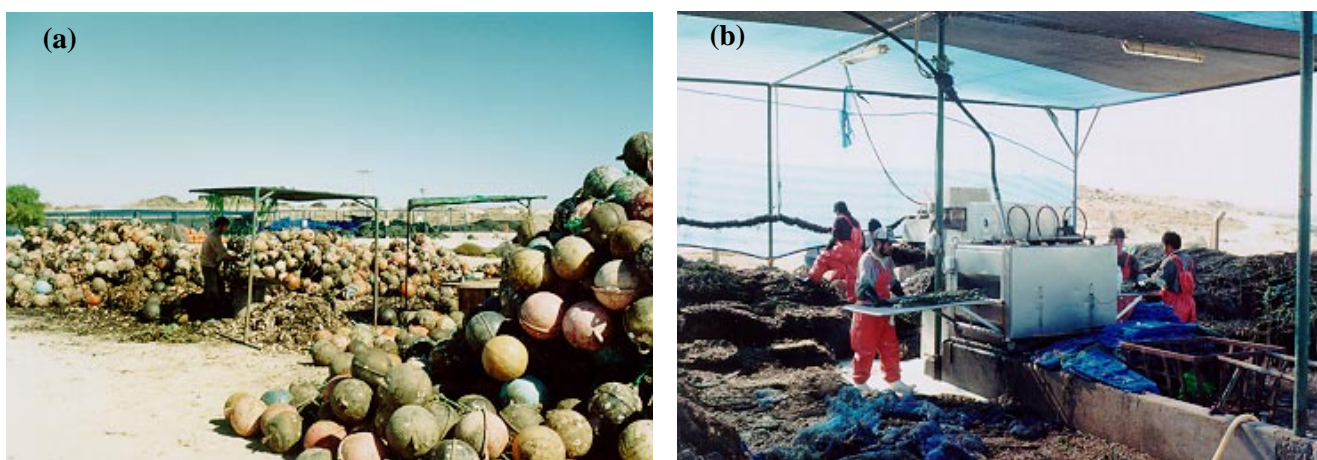
Figura 19.15. (a) Boyas empleadas en los sistemas de cultivo en suspensión "long-lines" en proceso de limpieza en Chile. (b) Proceso de limpieza de las unidades de cultivo en Chile, empleando hidrolavadoras.
